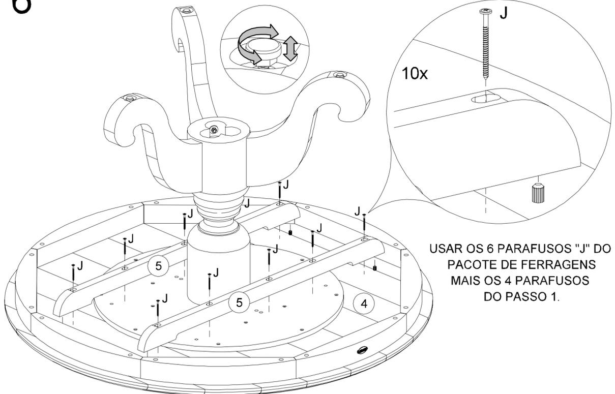
USAR OS 6 PARAFUSOS "J" DO PACOTE DE FERRAGENS MAIS OS 4 PARAFUSOS DO PASSO 1.
